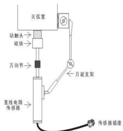
以某型号真空开关为例，如下图。直线电阻传感器在安装时，要保证传感器运动轴能够直线运动，用磁性万能支架固定好传感器。对于 SF6 开关、油开关，方法类似。
